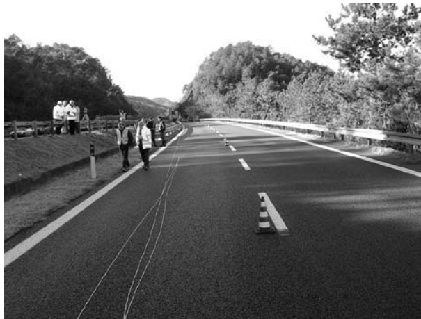
Figura 7.4 – Determinazione in loco della distanza di avvistamento.
