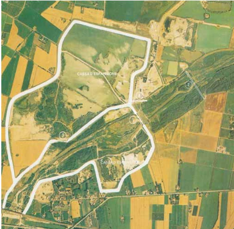
Figura 5. La cassa di espansione del fiume Secchia. 1) manufatto regolatore, sbarramento poco elevato posto sul fiume, che assicura il normale deflusso delle acque; 2) traversa, alla quale è affidata la stabilità dello sbarramento principale contro eventuali fenomeni di scalzamento; 3) sfioratore laterale, che consente il deflusso delle acque di piena nella cassa di espansione; 4) scaricatore, che permette alle acque accumulate nella cassa di defluire di nuovo in alveo.
