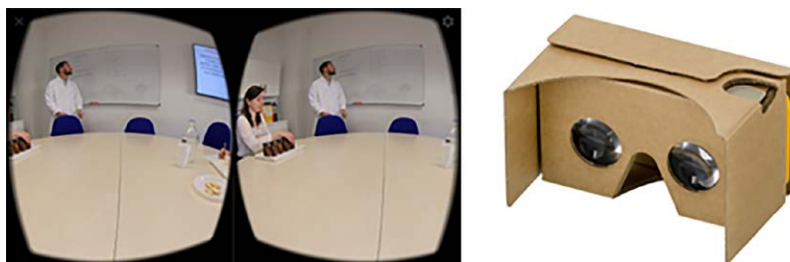
Figura 3 – Modalità immersiva di fruizione dei video a 360° su YouTube ed esempio di visore a basso costo (cardboard). Informazioni tecniche: videocamera = Insta360 One X; dispositivo di visualizzazione = personal computer, tablet, smartphone; livello di immersività = basso; interazione = no.
