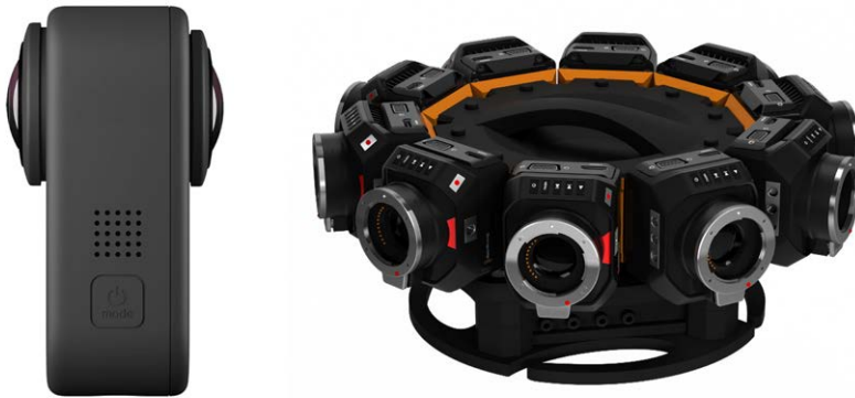
Figura 3 – Videocamera a 360° (a sinistra), RIG (a destra).
