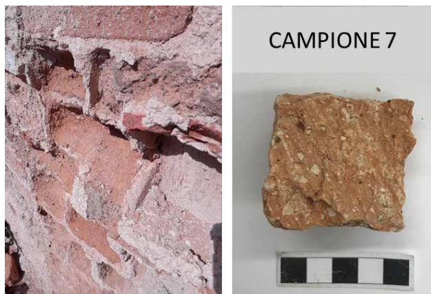
Fig. 16 - Campione 7: Punto di prelievo e foto del campione di laterizio. Muestra 7: Punto de muestreo y foto de la muestra de ladrillo.
