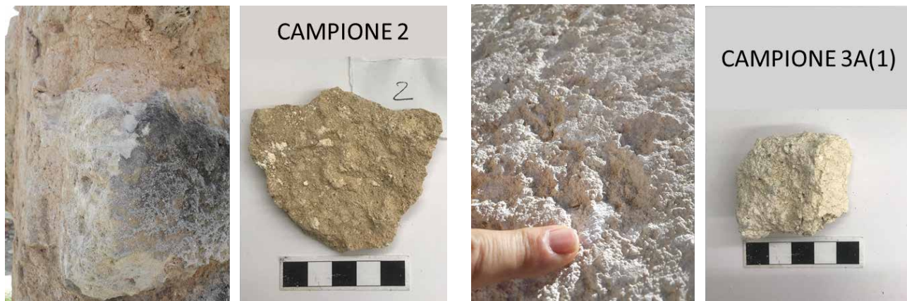
Fig. 8 - Campione 2 e 3A (1). Punto di prelievo e foto del campione di malta. Muestra 2 y 3A (1). Punto de muestreo y foto de la muestra de mortero.
