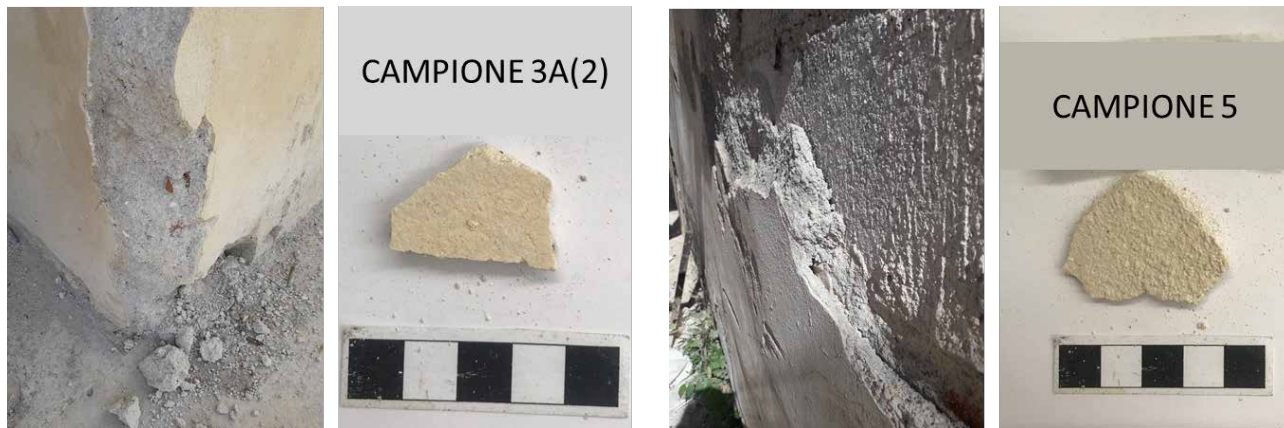
Fig. 10 - Campione 3A(2) e 5: Punto di prelievo e foto del campione di intonaco. Muestra 3A(2) y 5: Punto de muestreo y foto de la muestra de yeso.
