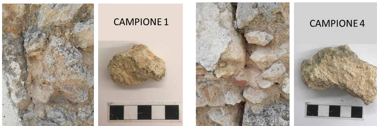
Fig. 18 - Campione 1, 4 e 8: Punto di prelievo e foto del campione del materiale lapideo. Muestra 1, 4 y 8: Punto de muestreo y foto de la muestra de piedra.
