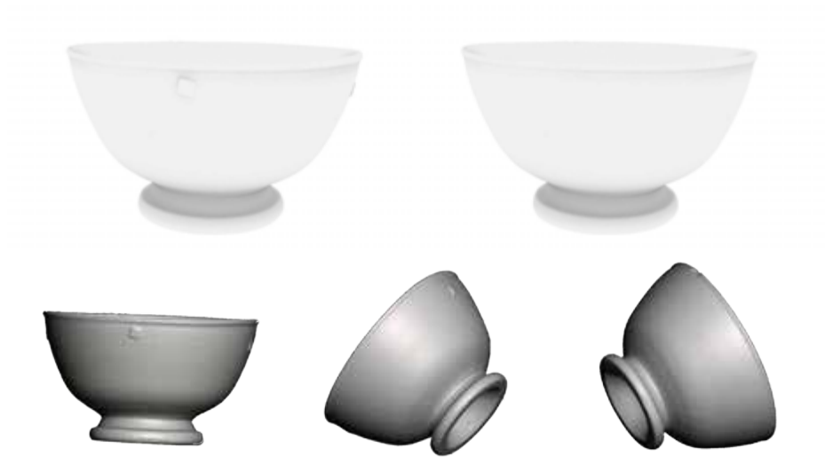
Fig. 120. I target utilizzati in fase di rilievo per consentire l'allineamento dei dati risultano ben visibili sulla superficie di modello, generando delle imperfezioni anche a livello di dato texture . Ritenu- ti superflui a livello descrittivo, sono stati eliminati attraverso azioni di pulitura e ottimizzazione.
