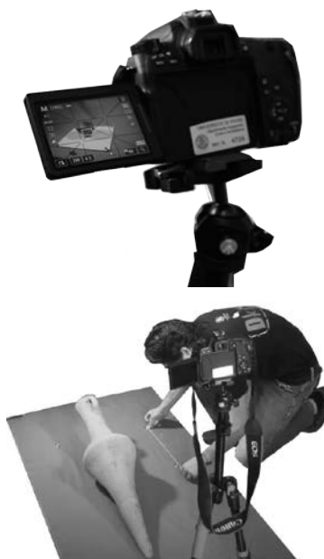
Fig. 99. La campagna di acquisizione fotogrammetrica è stata effettuata allestendo un set di ripresa: utilizzando tripod, teli fotografici e un set di luci regolabili che ha permesso di limitare la presenza di coni d'ombra sui reperti.
