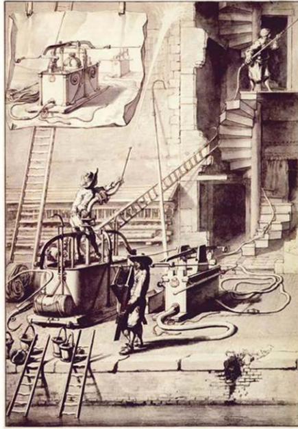
Figure 3 – Comparaison entre les anciennes et les nouvelles méthodes de lutte contre l'incendie ( Brandspuiten-boek , 1690). Jan van der Heyden montre les avantages de ces dernières inventions : un tuyau flexible et un engin anti-incendie plus performant.
