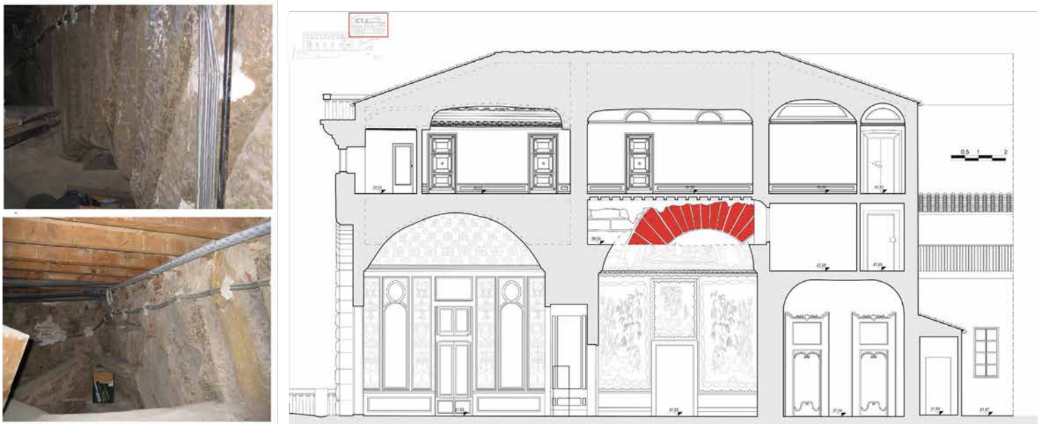
Fig. 27 - Palazzo Pitti, arcone del fianco meridionale (in rosso) inglobato dalla costruzione del Rondò delle Carrozze (ES 2014). Pitti Palace, arch of the southern side (in red) incorporated by the construction of the Rondò delle Carrozze.
