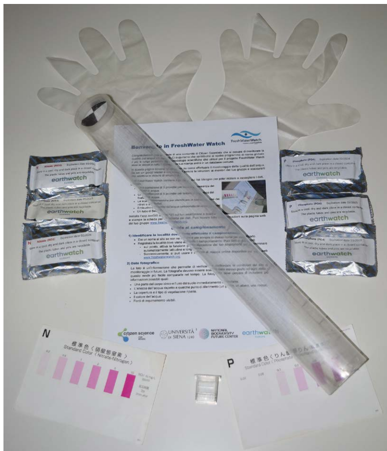
Figura 3.5 – Kit per la misura della qualità delle acque del progetto FreshWater Watch. Didascalia: il kit comprende un tubo Secchi per misurare la trasparenza dell'acqua, una cuvetta, due tabelle colorimetriche una per i nitrati e una per i fosfati, 15 test per nitrati, 15 test per fosfati, un bugiardino con le istruzioni di uso e un paio di guanti compostabili. Fonte: CS4Rivers s.r.l. [Foto: Francesco Di Grazia].
