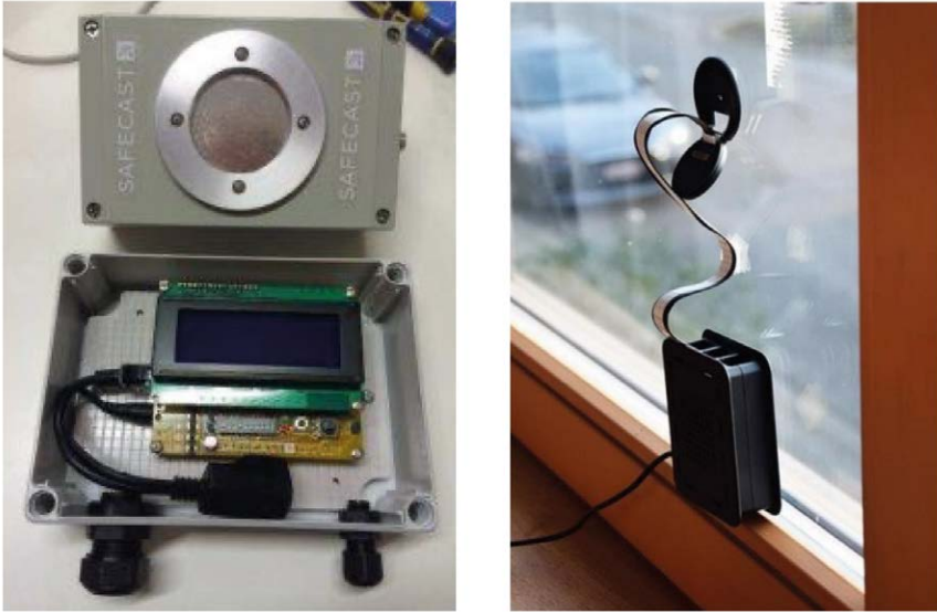
Fig. 3.6 – Sensori per il monitoraggio della radioattività e del traffico urbano. Didascalia: (a sinistra) il sensore bGeiger Nano è un contatore Geiger portatile e open source , disponibile in kit di assemblaggio ed utilizzato dal progetto Safecast; (a destra) il sensore Telraam che utilizza una telecamera e un sistema di intelligenza artificiale per contare biciclette, auto, camion e pedoni. Fonte: Safecast, Devices. Progetto Safecast (a sinistra); Progetto WeCount (a destra).
