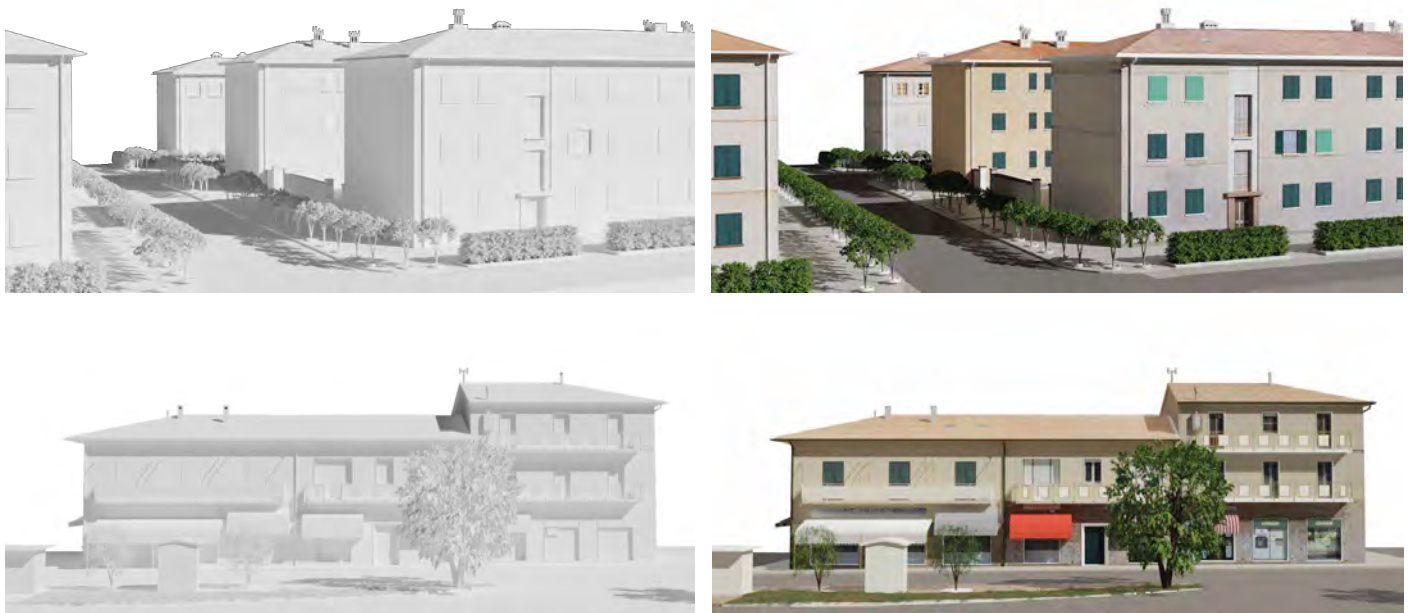
Fig. 12 Viste del modello 3D (senza texture /con texture ) di una porzione del comparto Pontedera e di piazza Monte alla Rena. La texture degli edifici è stata desunta da processi di fotogrammetria digitale, mentre per il terreno e la vegetazione sono state impiegate delle texture stock .
