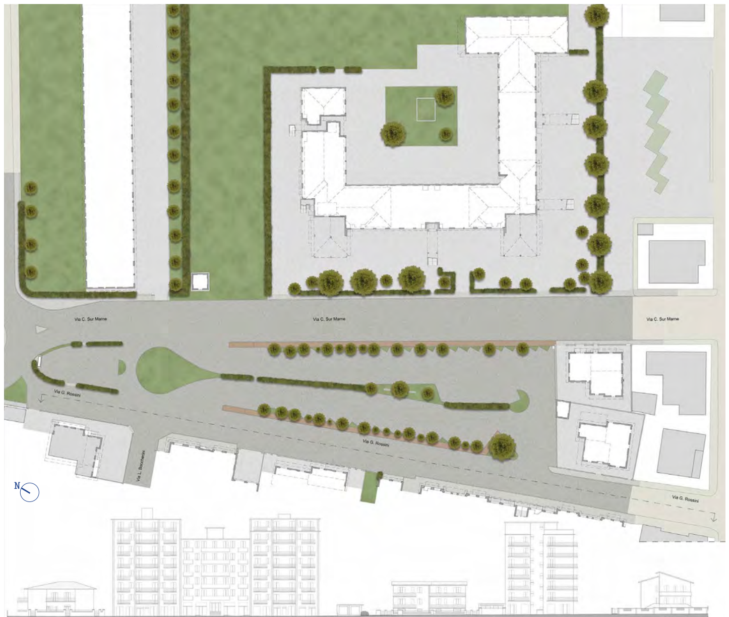
Fig. 17 Approfondimento comparto 167 (Tavola 4.8). Planimetria con inseriti i dettagli in pianta delle aperture a terra degli edifici insistenti su via Gioacchino Rossini e via Champigny Sur Marne. Sezione ambientale lungo via Gioacchino Rossini. Scala originaria di rappresentazione 1:200.
