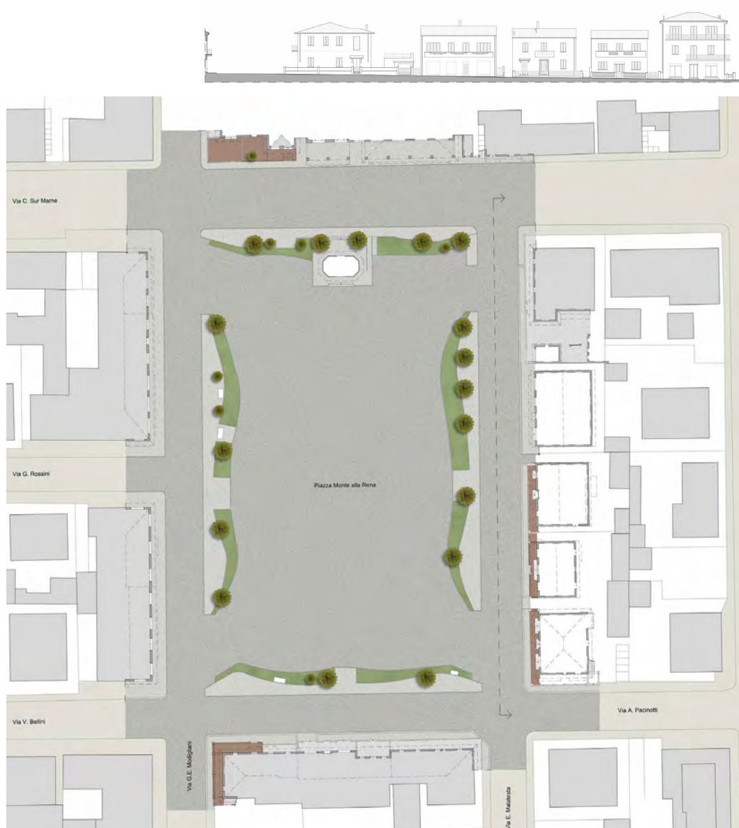
Fig. 16 Approfondimento piazza Monte alla Rena (Tavola 4.7). Planimetria della piazza con inseriti i dettagli in pianta delle aperture a terra degli edifici. Sezione ambientale del fronte meridionale. Scala originaria di rappresentazione 1:200.
