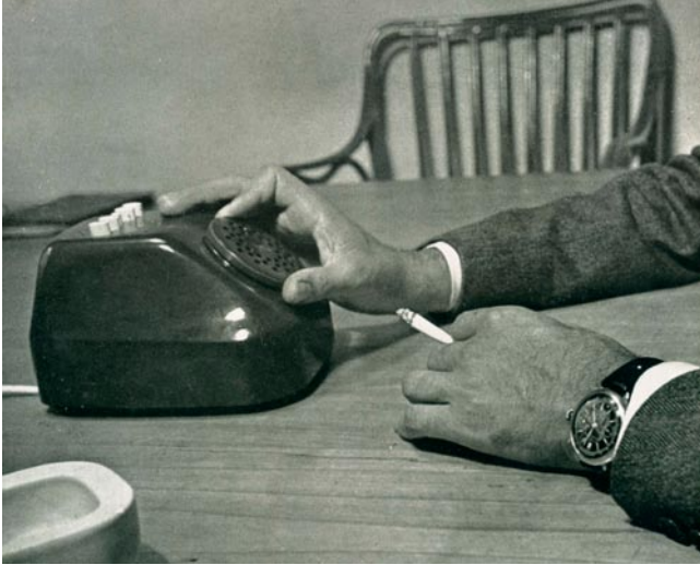
Fig. 15 – Luigi Caccia Dominioni, Livio e Piergiacomo Castiglioni, radio ricevitore a tre valvole, Modello 303 , Fimi-Phonola, 1940.
