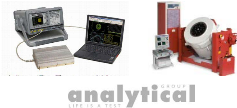
Figura 36 – Sistema di misura per il controllo di prove; banco vibrante e sistema automatico di misura in uso presso il Laboratorio.
