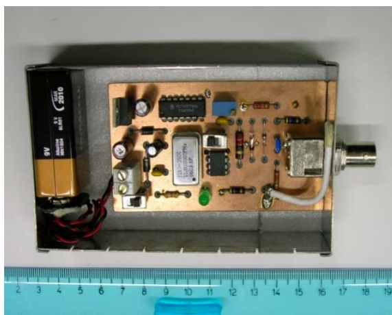
Figura 29 – Terza versione del generatore di pettine, realizzato dall'Ing. Cati mentre in Esaote S.p.A.
