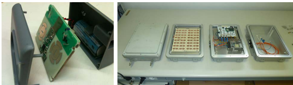
Figure 34 – A sinistra, prototipo dell'On-Board Unit per pedaggio interoperabile europeo; a destra, prototipo della Road-Side Unit per pedaggio free-flow.
