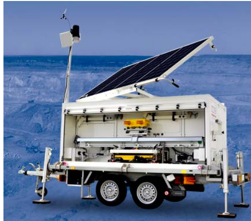
Figura 75 – Il GBSAR commerciale, prodotto da IDS S.p.A. (anno 2010 circa).
