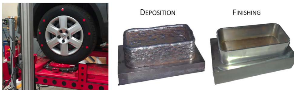
Figura 17 – A sinistra, dispositivo per la misura della convergenza e della campanatura sviluppato da ReViP; a destra, tecnologia WAAM studiata dal Laboratorio di Tecnologia Meccanica.
