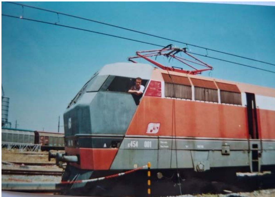
Figura 21 – 1998: l'allora studente di Ingegneria Meccanica Luca Pugi durante una sperimentazione su pantografo con controllo attivo della forza di contatto.
