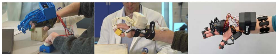
Figura 36 – A sinistra, uno dei primi prototipi in grado di assistere contemporaneamente le quattro 'dita lunghe' attraverso un azionamento a pulsante; in centro, il dispositivo migliorato dall'introduzione di un sistema di riconoscimento automatico dell'intenzione motoria; a destra, DANTE, l'ultima versione ulteriormente perfezionata dall'introduzione dell'assistenza indipendente a tutte le dita e di un potenziato sistema di riconoscimento automatico.
