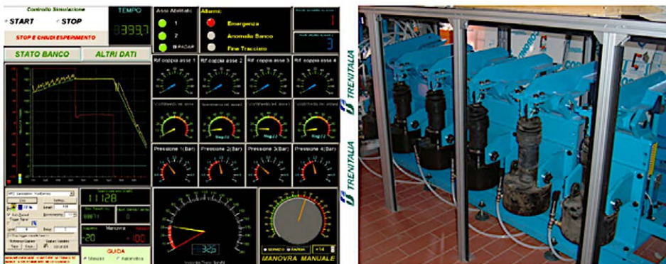
Figura 24 – Banco prova MI6; a sinistra, cruscotto di controllo; a destra, cilindri freno.
