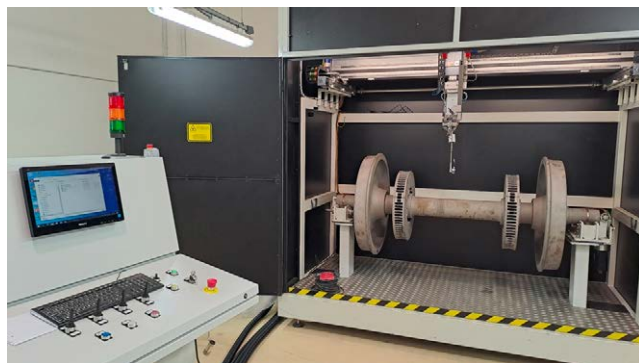
Figura 68 –Macchinario per l'ispezione automatizzata degli assi ferroviari con tecniche laser-ultrasuoni.
