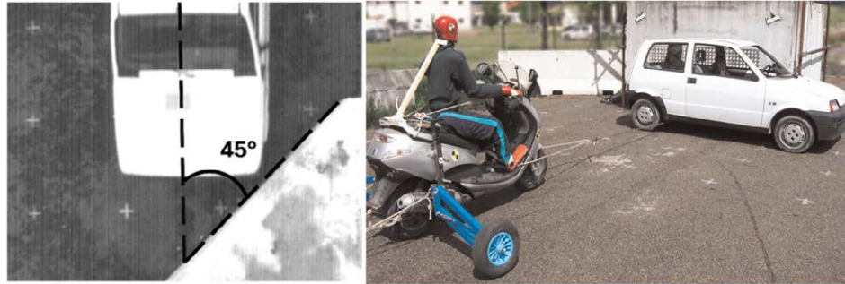
Figura 64 – Impatto tra auto e barriera inclinata a 45° su pista di crash (sinistra), impatto tra motociclo e auto (destra).
