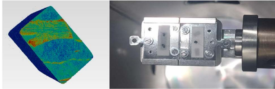
Figura 73 A sinistra, rendering 3D della meteorite Seymchan ottenuta per microtomografia di neutroni; a destra, Immagine dei due grani dell'asteroide Ryugu messi a disposizione dall'agenzia JAXA ed analizzati presso i laboratori Unifi.
