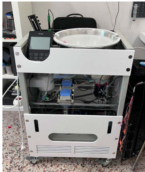
Figura 79 – Perfusore allestito per i test su fegati di maiale.
