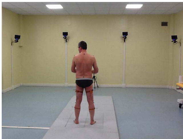
Figura 67 – Laboratorio di gait analysis di Fucecchio. Si notano quattro delle otto telecamere SMART e le due piattaforme di forza annegate nella pedana.
