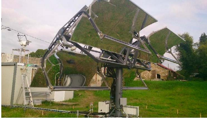
Figura 116 – Prototipo di sistema Fotovoltaico a concentrazione con recupero termico (CPV-T).
