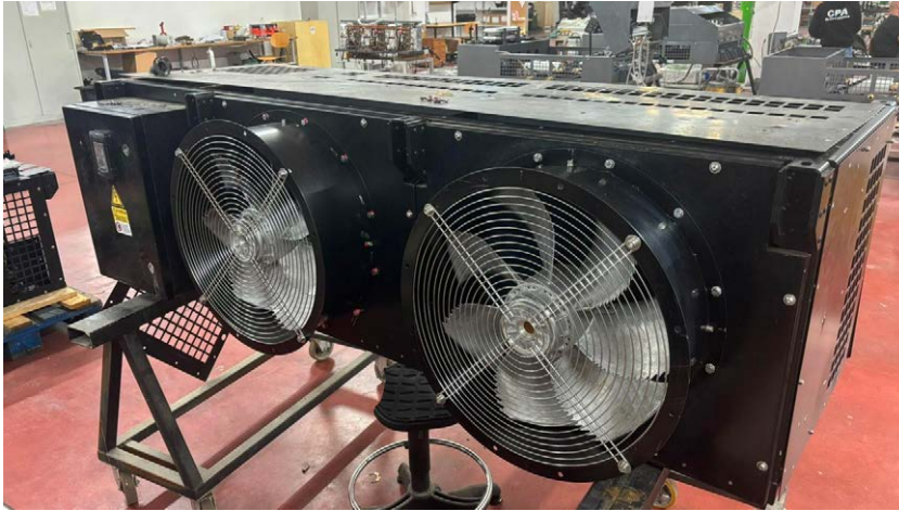
Figura 134 – Pompa di calore a CO 2 (sottocassa per applicazioni ferroviarie).
