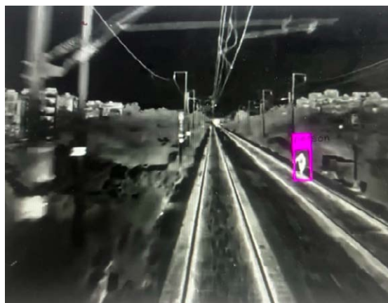
Figura 38 – Sistema di visione artificiale operante nel dominio termico: esempio di rilevazione di persone in prossimità dei binari.
