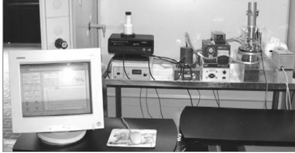
Figura 58 – Vista complessiva del respirometro realizzato in collaborazione con il Comune di Firenze.
