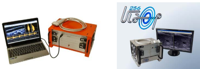
Figura 85 – Gli ecografi ULA-OP, a 64 canali, e ULA-OP256, specializzato nell'elaborazione ultraveloce dei segnali ecografici da 256 trasduttori
