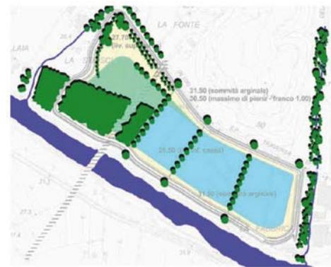
Fig. 4 – Schema plani-volumetrico indicativo delle misure di inserimento paesistico della cassa di espansione e di equipaggiamento arboreo del parco pubblico a Limite (Disegno di G. Paolinelli).
