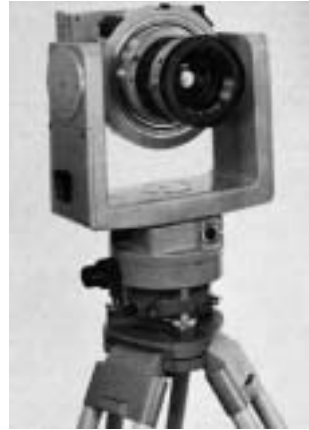
Fig. 46 – Camera metrica terrestre.
