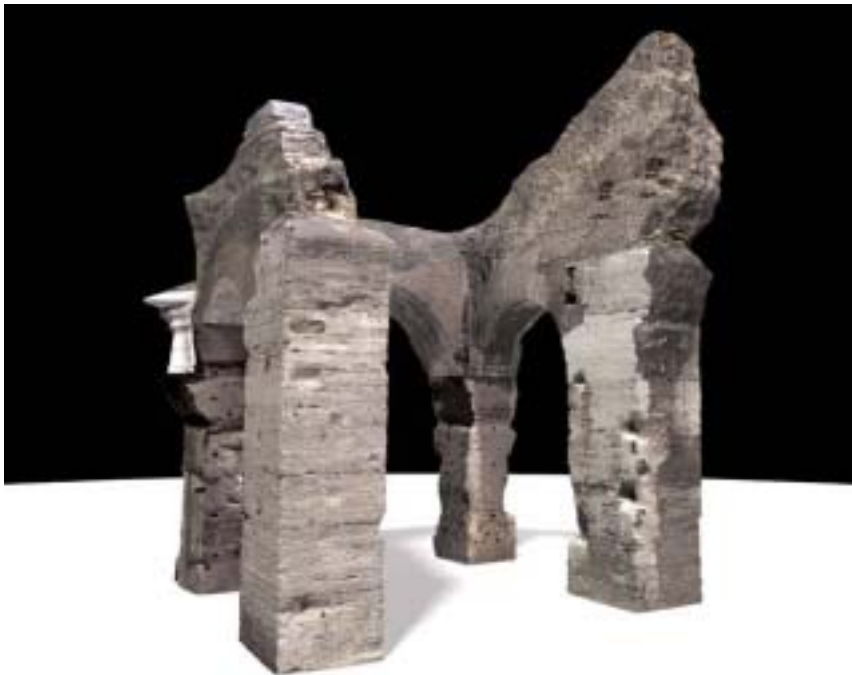
Fig. 19 – Rilievo mediante laser scanner 3D: modello 3D texturato del cuneo dell'ingresso nord del Colosseo in Roma.
