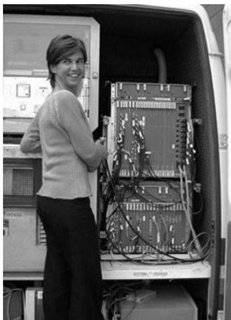
**Figura 34.** Prototipo funzionale terminale mobile UMTS (1998).
