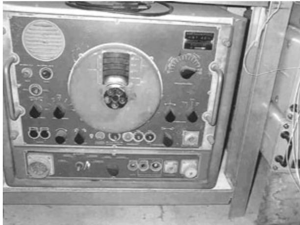
Figura 12. Ricetrasmittitore RT4/D.
