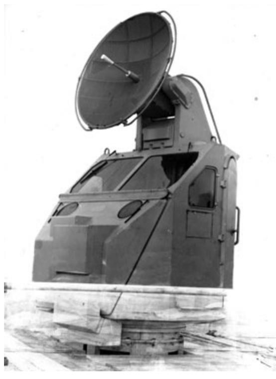
**Figura 16.** L'Orion, capostipite dei radar di tiro (per cortese concessione di Selex Sistemi Integrati).
