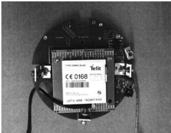
Sensore di una *wireless sensor network* su base Zigbee (breve raggio) e rete cellulare (lungo raggio). La parte cellulare è garantita dal chip Telit – di fabbricazione italiana – al centro della scheda.
