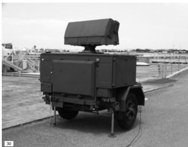
**Figura 29.** Il sistema Shorar (per cortese concessione di Rheinmetall Italia).
