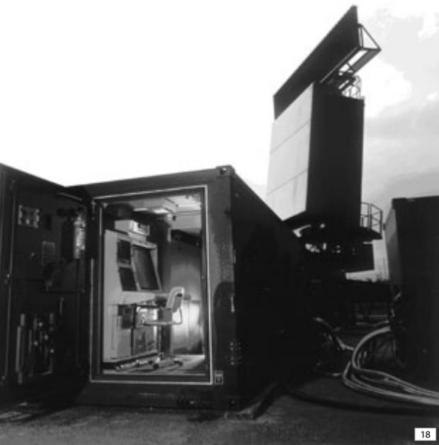
**Figura 17.** Il radar di tiro navale monopulse coerente RTN 30 X (per cortese concessione di Selex Sistemi Integrati).
