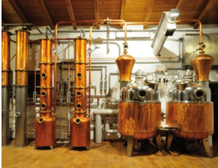
Doppio impianto a bagnomaria con colonna di distillazione Azienda agricola Francesco Poli. Distilleria a S.Massenza, Vezzano (TN) (Foto Alessandro Poli)
