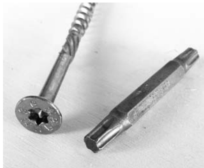
Figura 7. Vite e punta Torx da cacciavite o avvitatore
