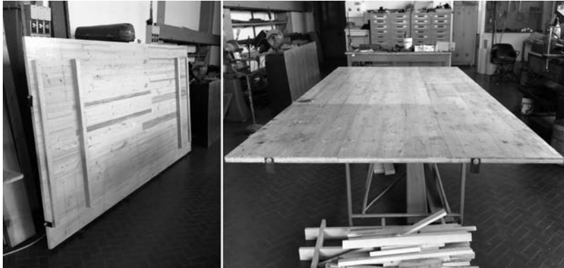
Figura 8. Piano di lavoro in pannelli di legno per casseforme edili
