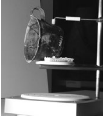
Figura 1. Base rotante e sistema di bloccaggio dell'oggetto per mantenerlo nella posizione desiderata per l'acquisizione.
