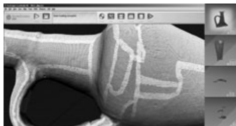
Figura 11. Dopo l'allineamento e la pulizia di tutte le «famiglie» (visualizzazione del reticolato poligonale del modello di superficie – wireframe ).
