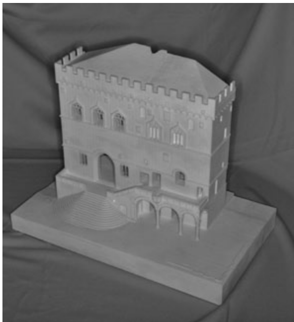
Figura 7. Test per la realizzazione di modelli tattili dei principali edifici del centro storico di Perugia (stampa 3D) – Modellazione a cura del Laboratorio GeCo, progetto in collaborazione con il Comune di Perugia, U. O. Beni Culturali, 2010.
