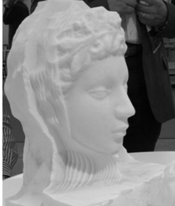
Figura 6. Replica in marmo di statua di Profeta (Firenze) in fase di lavorazione (fresa a controllo numerico), progetto in collaborazione con l'Opera del Duomo di Firenze, 2005.
