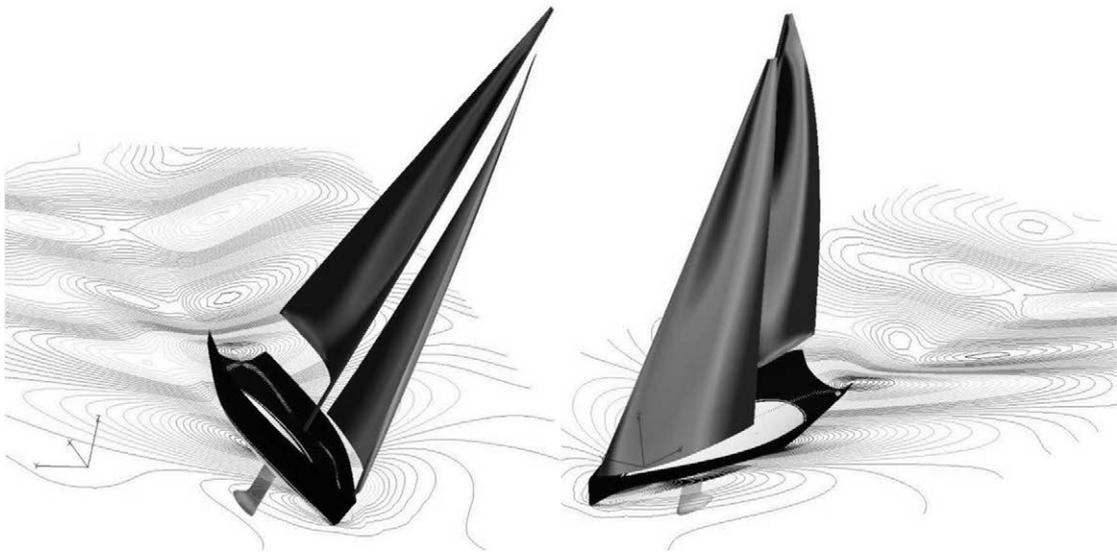
Campo di pressione intorno alle vele e sistema d'onde generate dalla carena (calcolo numerico CFD).
