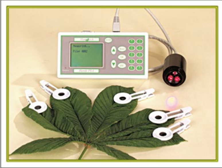
Figura 7.2 – Fluorimetro FMS2 (Hansatech), per la misura della fluorescenza modulata della clorofilla a in vivo ( http://www.Hansatech-instruments.com/fms2.htm ).
