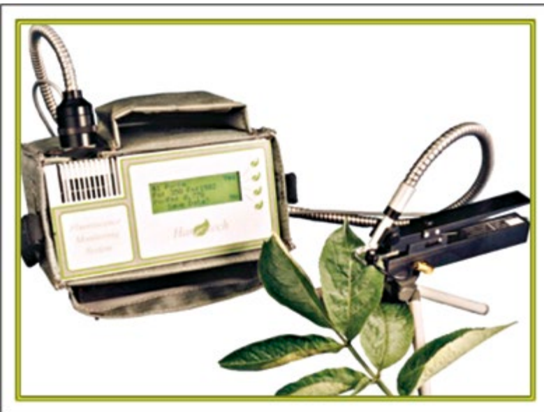
Figura 7.2 – Fluorimetro FMS2 (Hansatech), per la misura della fluorescenza modulata della clorofilla a in vivo ( http://www.Hansatech-instruments.com/fms2.htm ).
