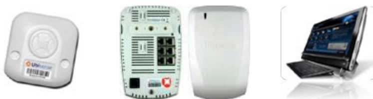
Fig. 1. Componenti sistema UWB Ubisense (da sinistra): Tag “Compact”, Sensore, Computer
