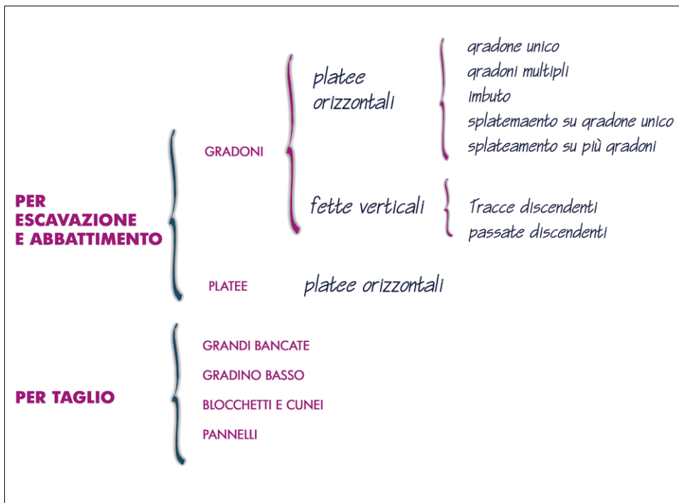
Fig. 3.5 Metodi di coltivazione a cielo aperto
