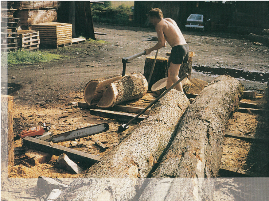
Figura 1 – Operazione di spacco dei topi di rovere (per gentile concessione della ditta Gamba).
