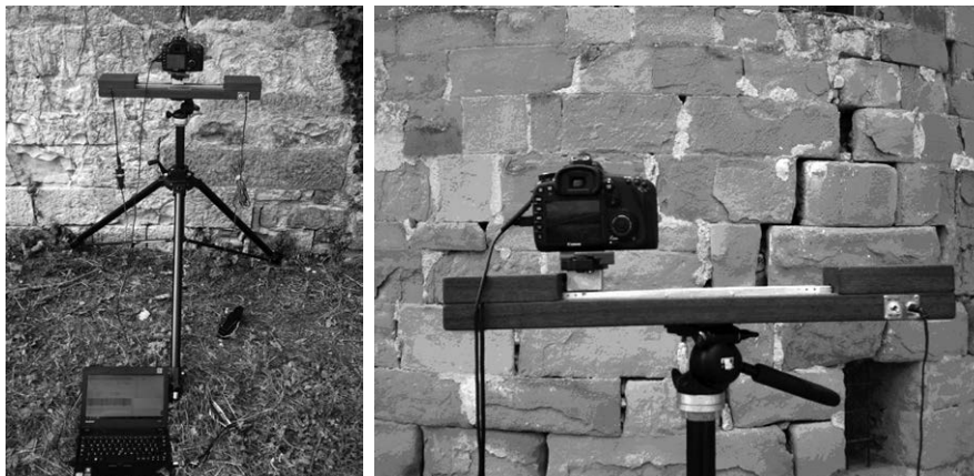
Fig. 18 – L'attrezzatura necessaria per il rilievo sul campo presso la Pieve di San Gavino Adimari nei pressi di Barberino di Mugello (FI) ed un momento di acquisizione delle triplette fotografiche presso la Pieve di San Cassiano in Padule a Vicchio (FI).
