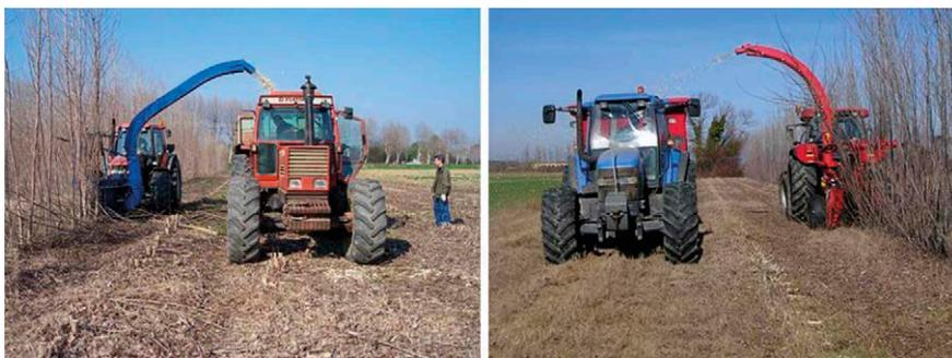
Figura 56 – Cantieri separati: a) abbattimento e b) concentrazione di SRF di pioppo.
