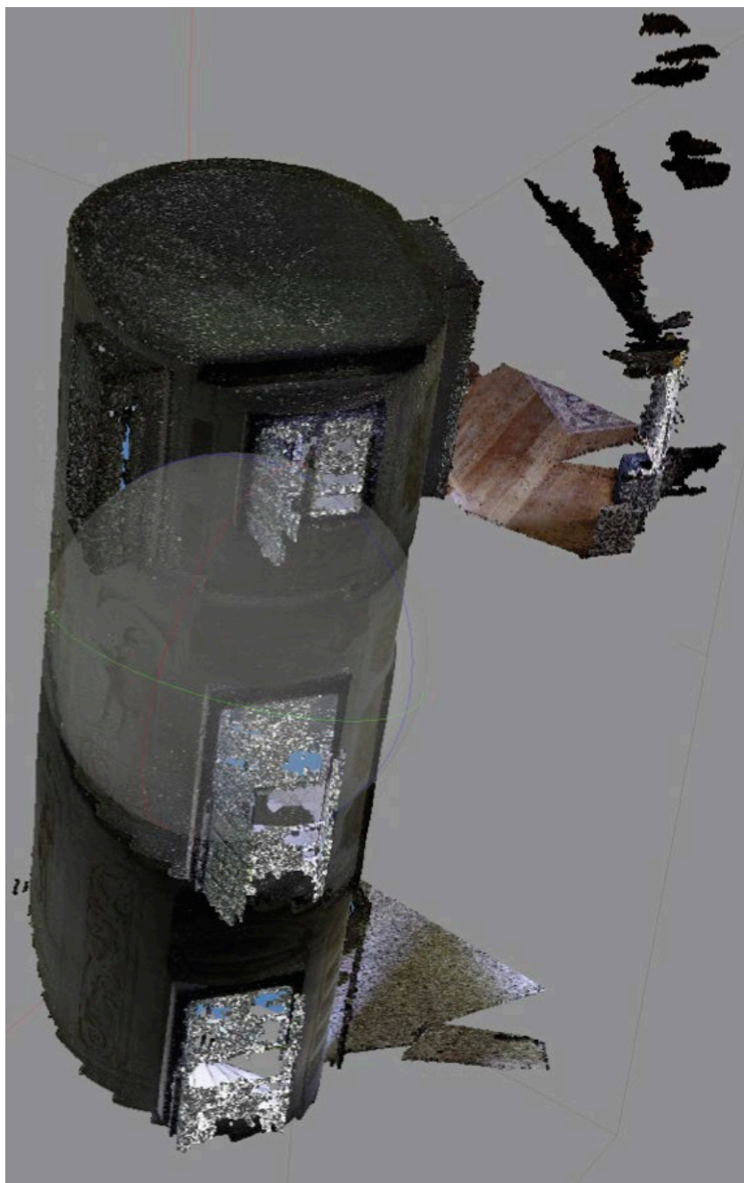
Figura 4. Elaborazione delle fotografie scattate presso la scala affrescata di villa Valier Bembo a Mira: screenshot da Agisoft PhotoScan.
