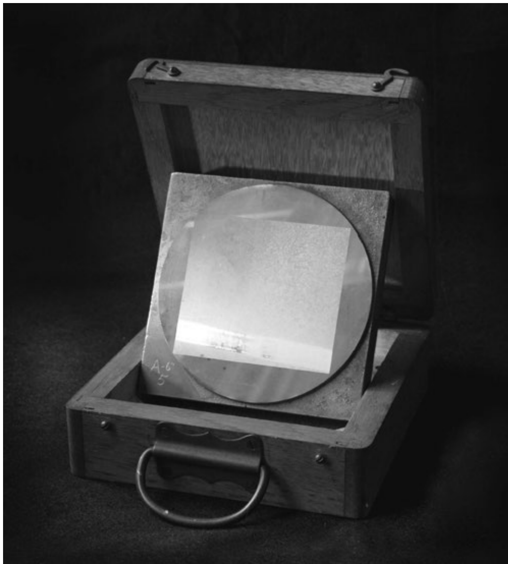
Fig. 14 – Reticolo di diffrazione costruito dai tecnici di Mount Wilson per lo spettroeliografo della Torre Solare di Arcetri. [INAF-Osservatorio Astrofisico di Arcetri]
