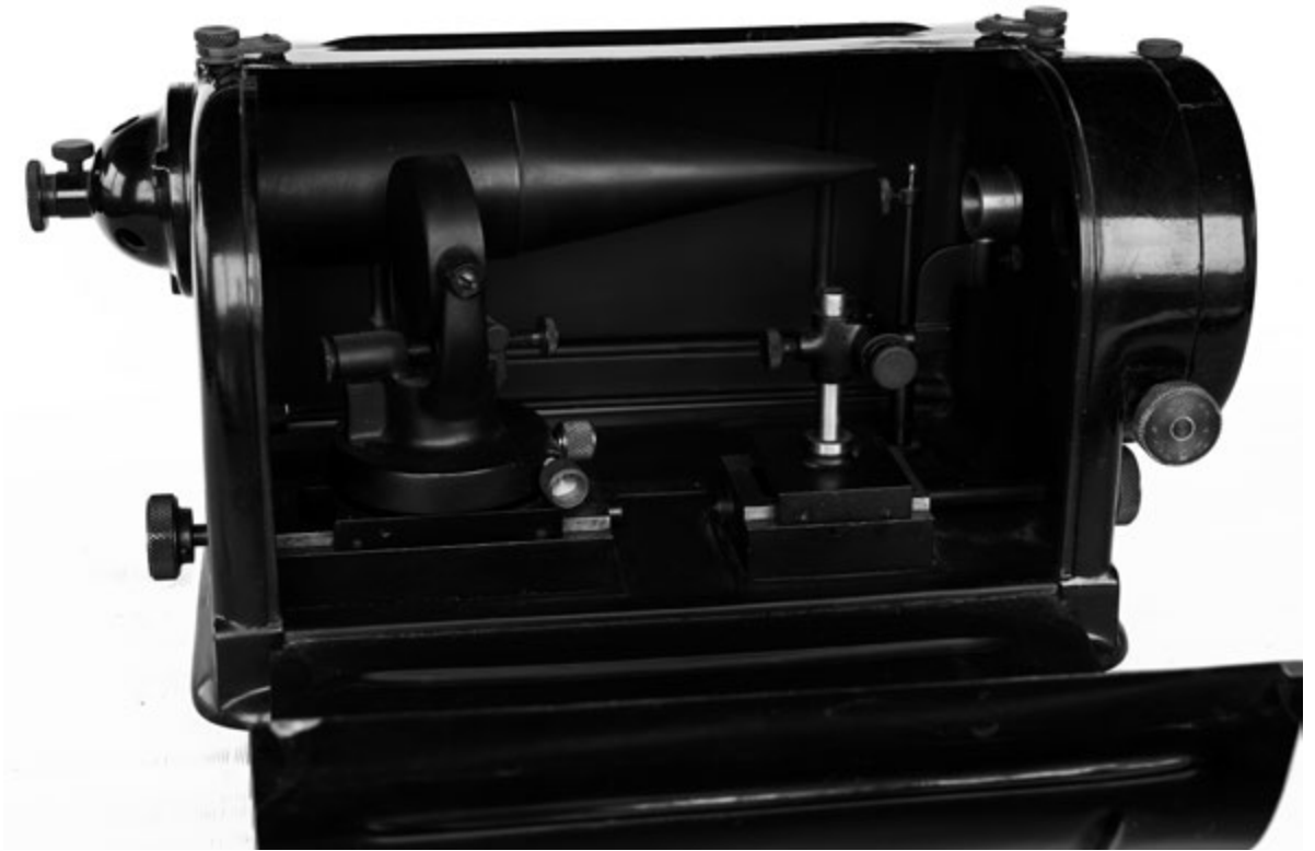
Fig. 9 – Risolvimetro interferenziale: strumento (progetto R. Brusaglioni) utilizzato nel 1938 all'Istituto di Ottica dalla dott. ssa Crinò per misurare il potere risolutivo delle emulsioni fotografiche.
