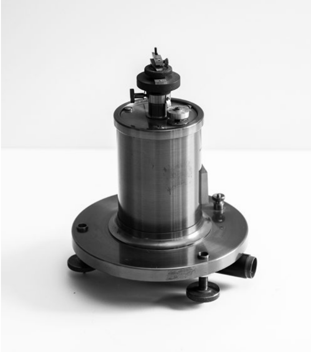
Fig. 5 – Elettrometro Compton, costruito dalla Cambridge Instrument Co. Ltd, England, 1930 circa. Dimensioni: diametro base cm 17, altezza cm 23. Si tratta di un elettrometro a quadranti nel quale l'equipaggio mobile è costituito da un settore di alluminio sospeso al centro di due coppie di quadranti. Lo strumento ideato dal fisico americano Arthur Compton è una modifica dello strumento proposto da Dolezalek e diversamente da questo permette di modificare la posizione di uno dei quadranti. [Dipartimento di Fisica e Astronomia, Università di Firenze]
