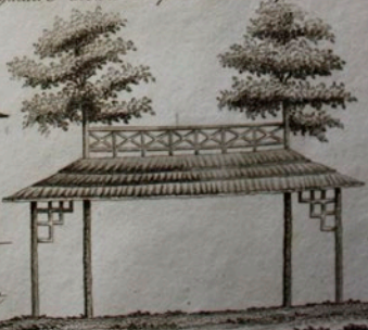
Abri contre le soleil, supporté par deux arbres, et par quatre piliers, decorés d'ornemens Chinois.
