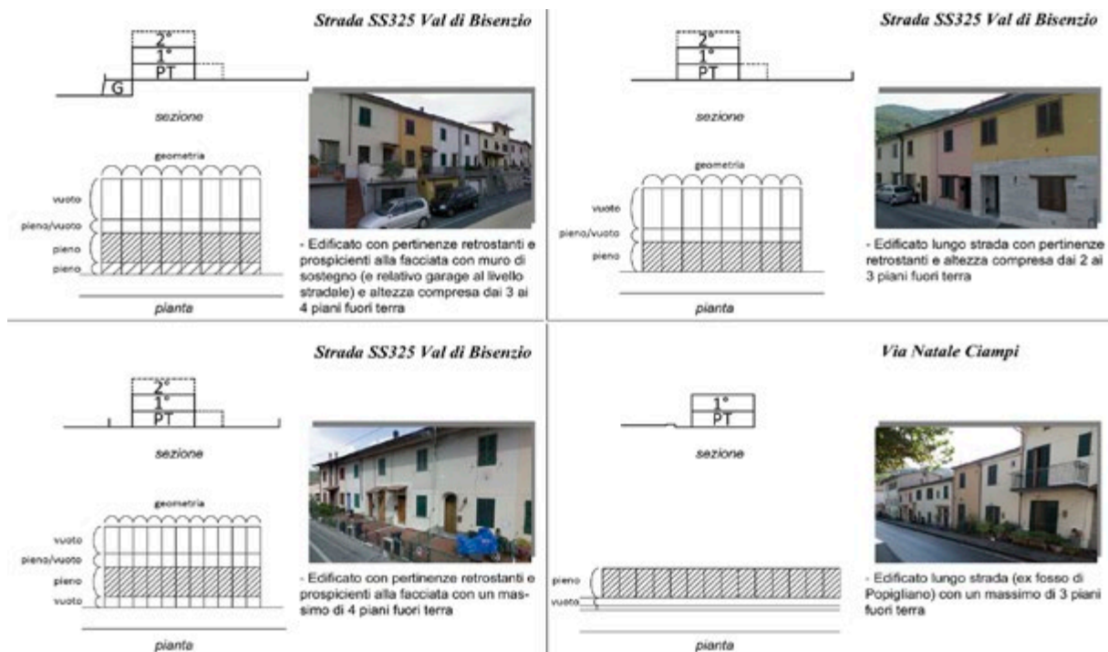
Figura 2. Le invarianti strutturali geometriche.
