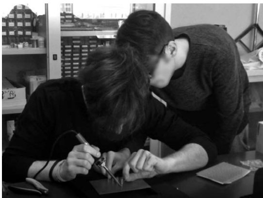
Figura 6 – La saldatura dei collegamenti elettrici.
