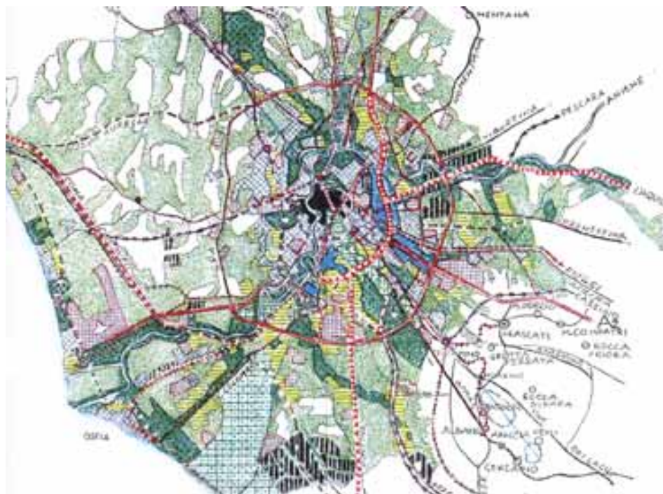
Figura 22. Sintesi schematica della zonizzazione del PRG 1962: sono indicati in nero il centro storico, a quadretti la città consolidata, a righe orizzontali le nuove espansioni; in blu i centri direzionali, a quadretti rossa i servizi e a righe verticali nere le aree industriali; in bianco le aree agricole e nei toni del verde i parchi, le aree vincolate e le aree a verde pubblico.
