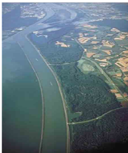
Figura 17. Esempio di retention area.
