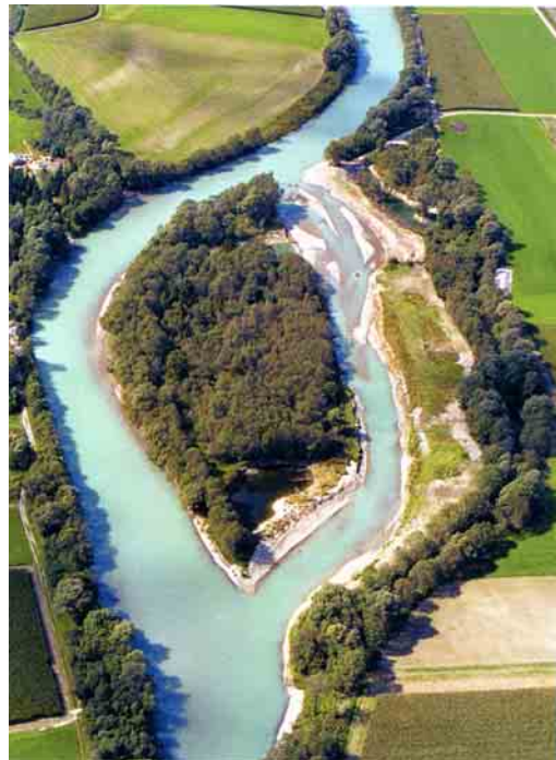
Figure 17-18. “Prima e dopo”: costruzione di un braccio parallelo al fiume lungo cinquecento metri. Al centro si è creata un’isola di circa tre ettari, oggi classificata riserva naturale.
