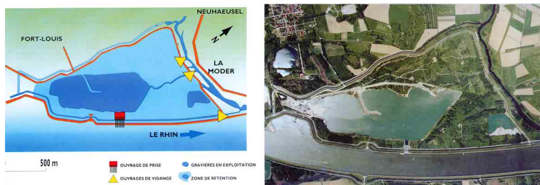
Figura 4. Cassa d'espansione in derivazione: schema e foto.
