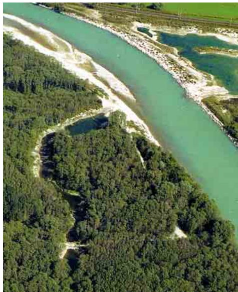
Figura 19. Estensione della riva interna attraverso la costruzione di un’area fluviale aggiuntiva di tre ettari che si ricongiunge al fiume più avanti.
