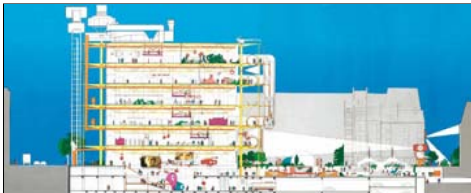
Fig. 7 Centre Georges Pompidou, Parigi: sezione del progetto per il concorso. L'edificio è concepito come un centro di informazione nel cuore della città, connesso con il resto del mondo (RRP - RRP).
