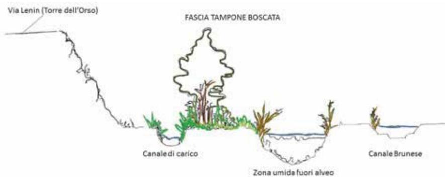
Figura 3 - Schema di progetto di una fascia tampone con canale di carico per il trattamento dei carichi di azoto (N) e fosforo (P) convogliati dal deflusso sotterraneo.
