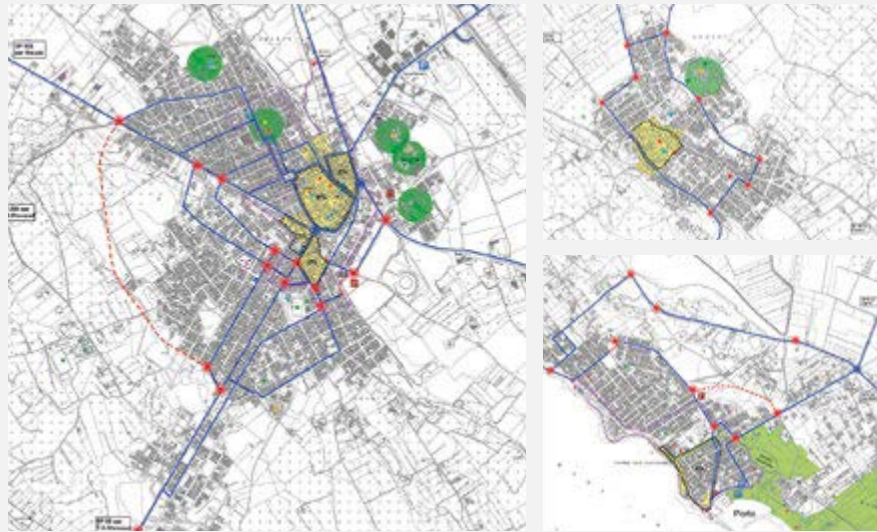
Figura 1. PGTU e Linee Guida PUMS, 3.7 Ugento, 3.8 Gemini e 3.9 Torre San Giovanni. Principali interventi di fluidificazione della rete stradale (in rosso); le tre ZTL di progetto (bordate in nero); le aree oggetto di moderazione del traffico (in verde).
