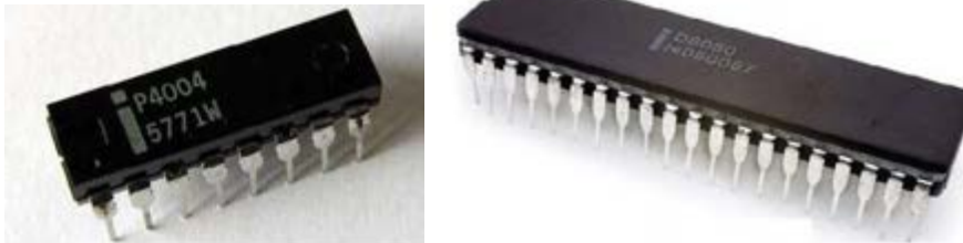
Due dei primi microprocessori: a sinistra il 4004 (4 bit), a destra l'8080 (8 bit).
