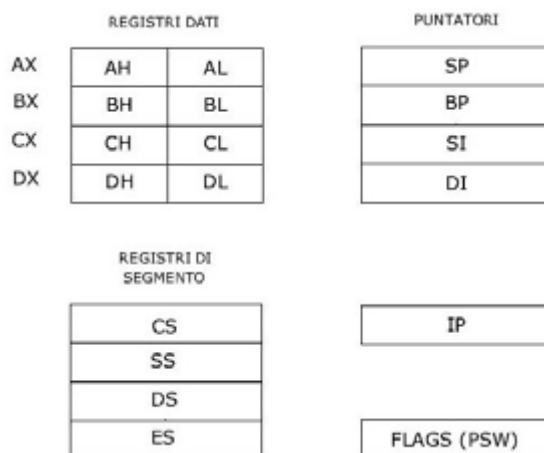
Modello di programmazione 8086/8088.
