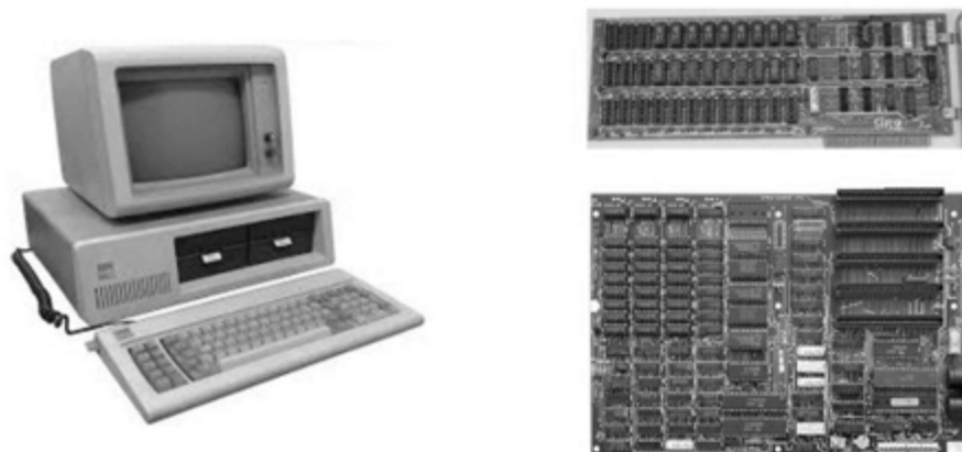
A sinistra il PC IBM, introdotto il 12 Agosto 1981. A destra una scheda di espansione (di memoria) e la piastra madre.
