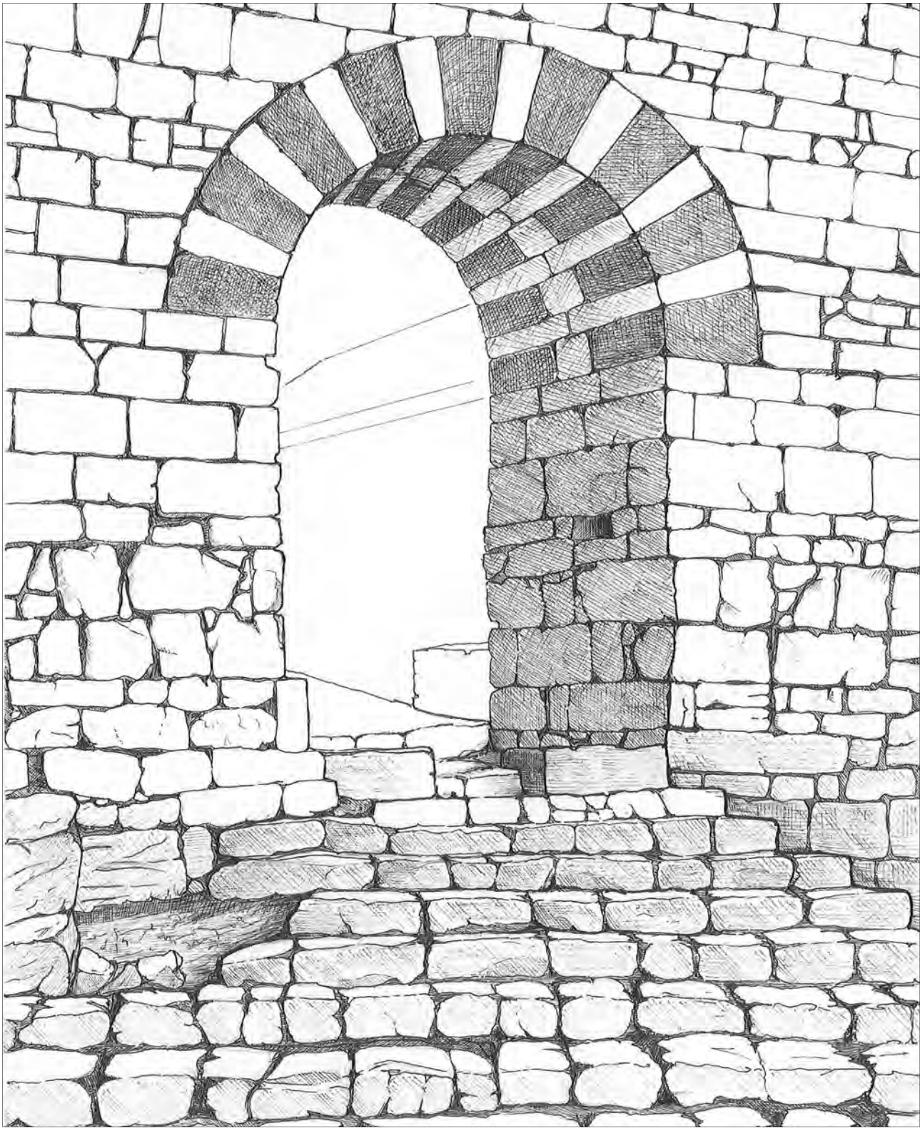
Figura 17 Ipotesi ricostruttiva della porta di accesso al borgo, con inserimento dei conci in pietra chiara e pietra scura rinvenuti nell'area archeologica (disegno di Mario Giuliano)
