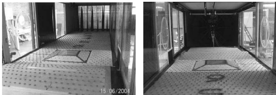
Fig. 51 Foto del modello della discarica utilizzato nelle prove in galleria del vento
