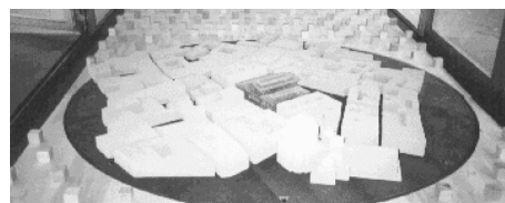
Fig. 27 Foto del modello della copertura posta all'interno della galleria del vento
